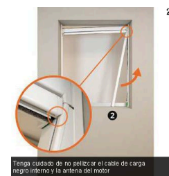
Ajuste la longitud del cable de carga interno negro usando la fórmula: Agujero H - 17 cm
