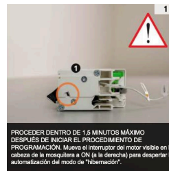
Para asociar un control remoto, presione el botón P1 visible desde el orificio correspondiente en la cabeza de la mosquitera, hasta que el motor gire una vez hacia arriba y hacia abajo y emita una señal acústica.
